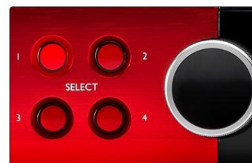
Wählen Sie Schaltflächen / Encoder eingeben Rot 4Pre gezeigt
